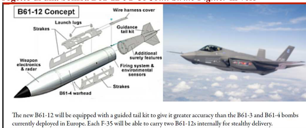
Figura 4: Progetto di una bomba B61-12 e F-35 Joint Strike Fighter in volo
